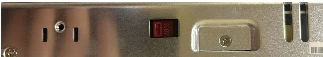
Рисунок 14. Тумблер смены режима питания
